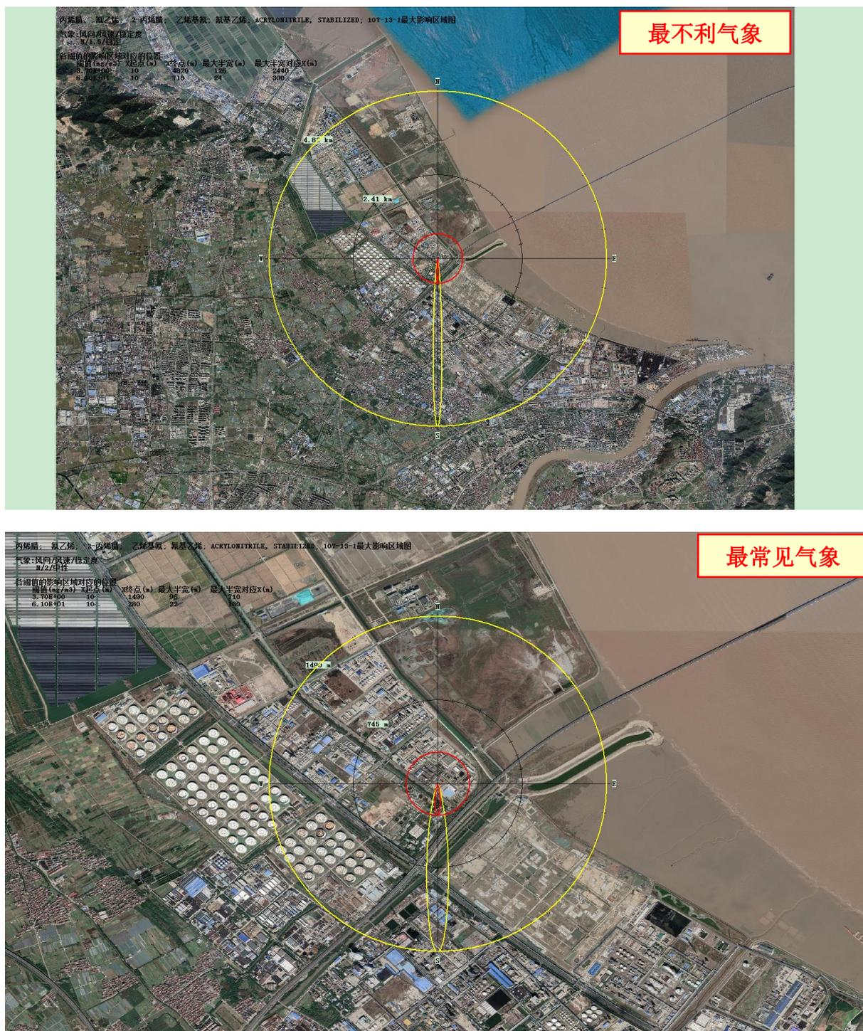
图 8.6-2 丙烯腈储罐泄漏形成液池蒸发扩散后最大影响区域敏感点浓度
