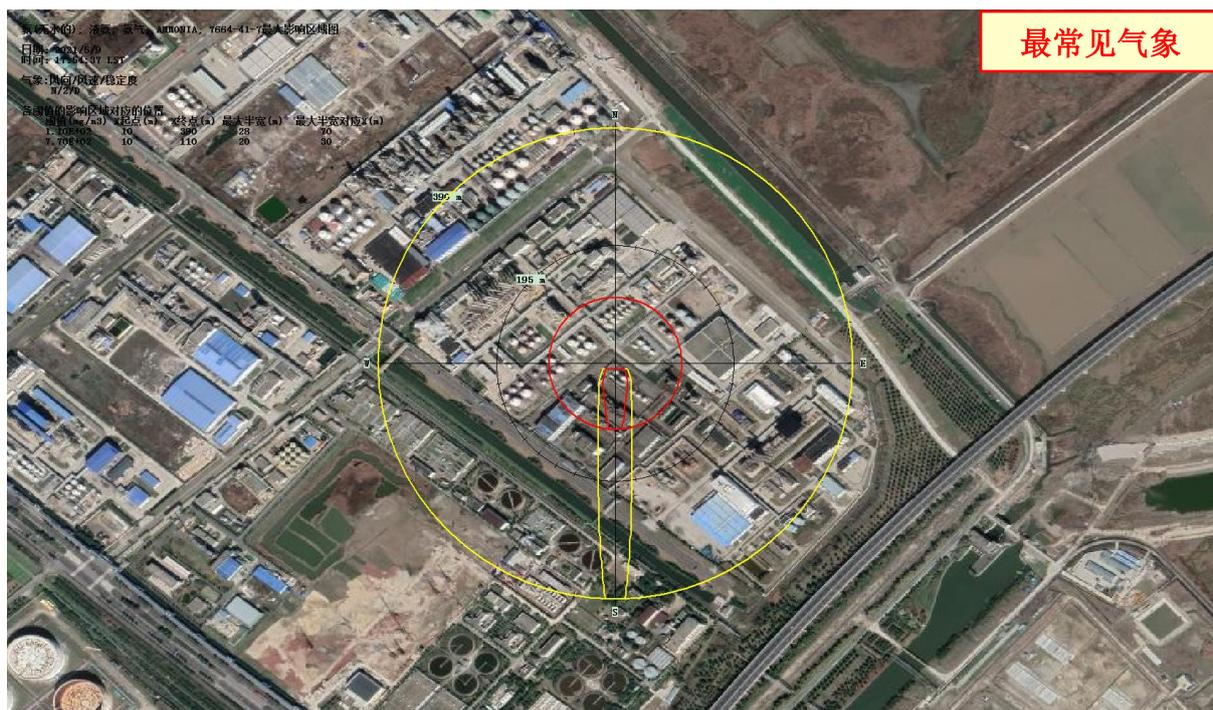
图 8.6-10 液氨泄漏事故最大影响区域图
