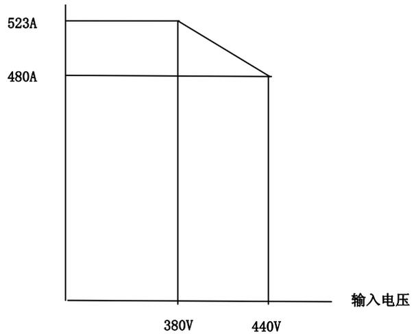
\*3. T310 机种是设计在重负载使用的负载条件下，出厂设定以 H.D.(重负载型为基准)，过载能力为 150%/1 分钟，载波及出厂设定请参考下表。
