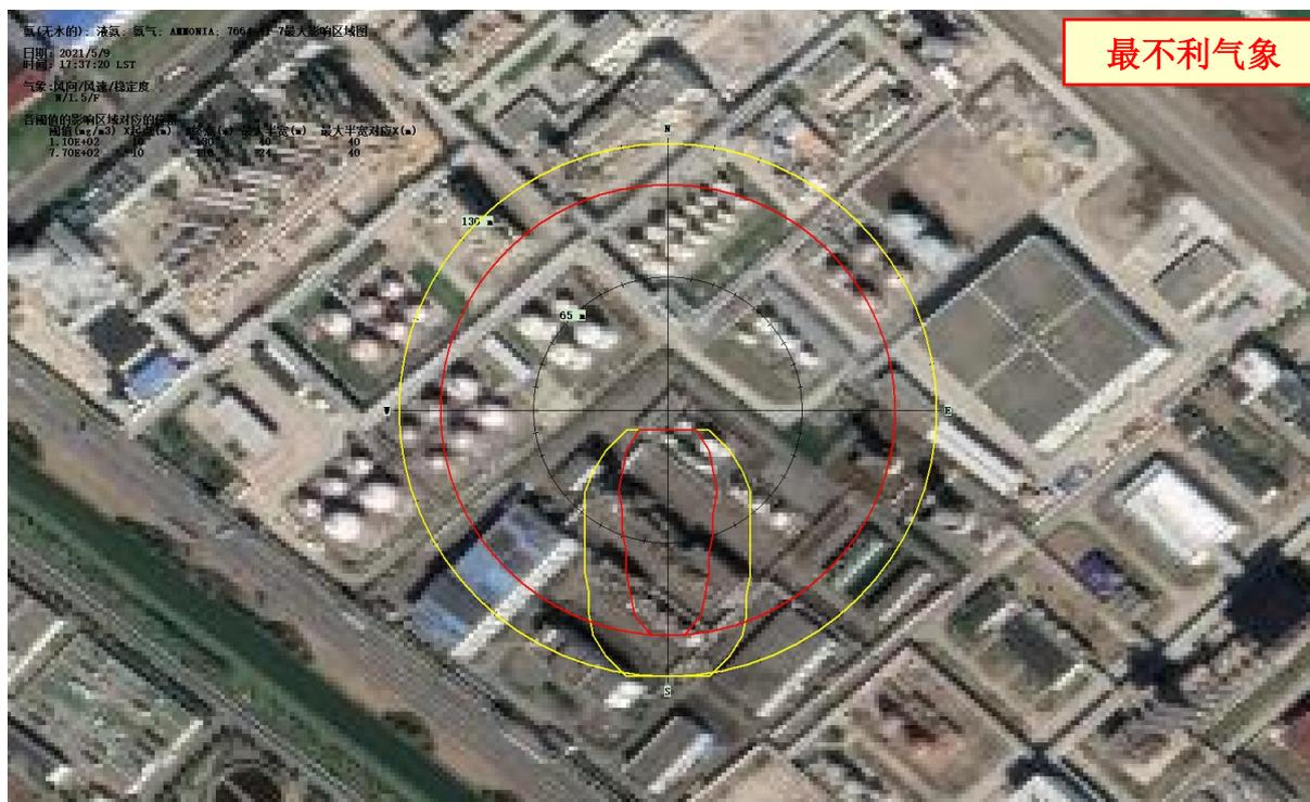
图 8.6-7 液氨储罐泄漏事故最大影响区域
